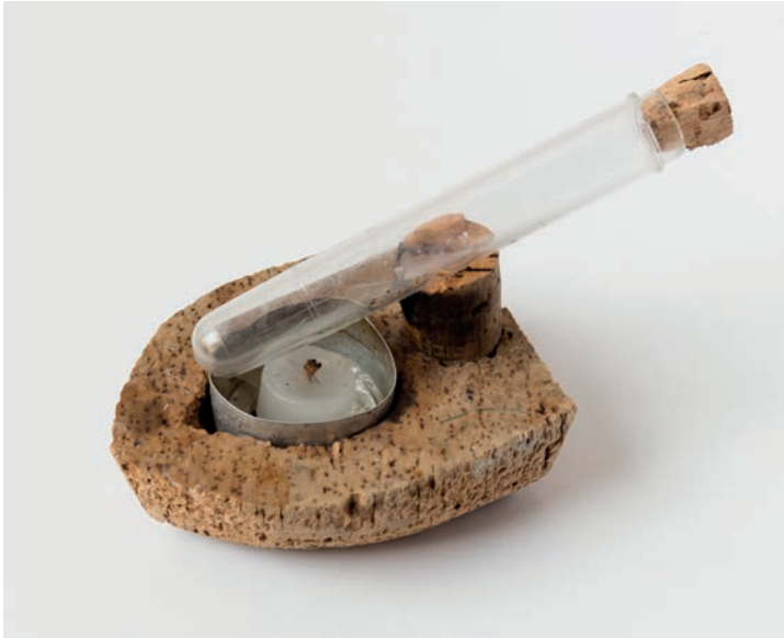
FIGURA 10. Vaixell de vapor . El buc és un tros de suro dins del qual hi ha una espelma que contacta amb un tub de vidre amb tap de suro on es posa aigua. Quan l'espelma s'encén, l'aigua s'escalfa, bull, i el vaixell es mou impulsat pel vapor (MJCF 112936). Foto: Jordi Puig.
