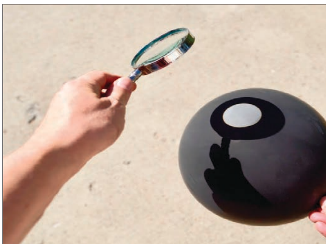
Figura 5.11. Comparació de l'efecte d'un feix de llum concentrat amb una lupa sobre globus de diferents colors, en què es pot observar que els globus més foscos exploten abans, ja que absorbeixen més llum. Font: elaboració pròpia.
