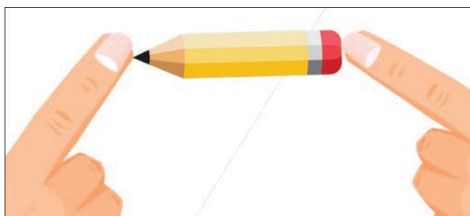
Figura 3.9. Persona prement un llapis per dos extrems amb diferent superfície de contacte. Tot i fer la mateixa força, la punta del llapis exerceix molta més pressió sobre el dit que l'extrem. Font: elaboració pròpia.
